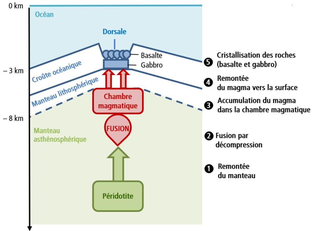
Schéma fonctionnel de la production de magma au niveau d'une dorsale
